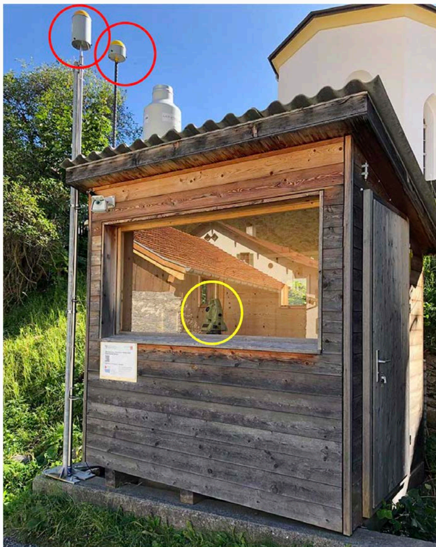
Das Messhäuschen bei der Kirche mit dem Laser-Tachymeter (gelber Kreis) und den Empfängern für die Satellitensignale (rote Kreise). Bild: HMQ
