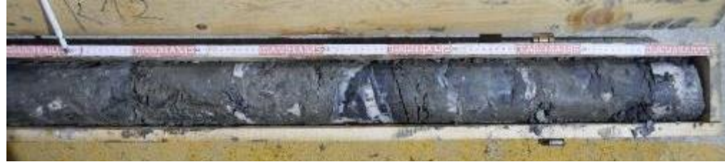
KB2, 32 m: Rutschmasse, verlehmt
