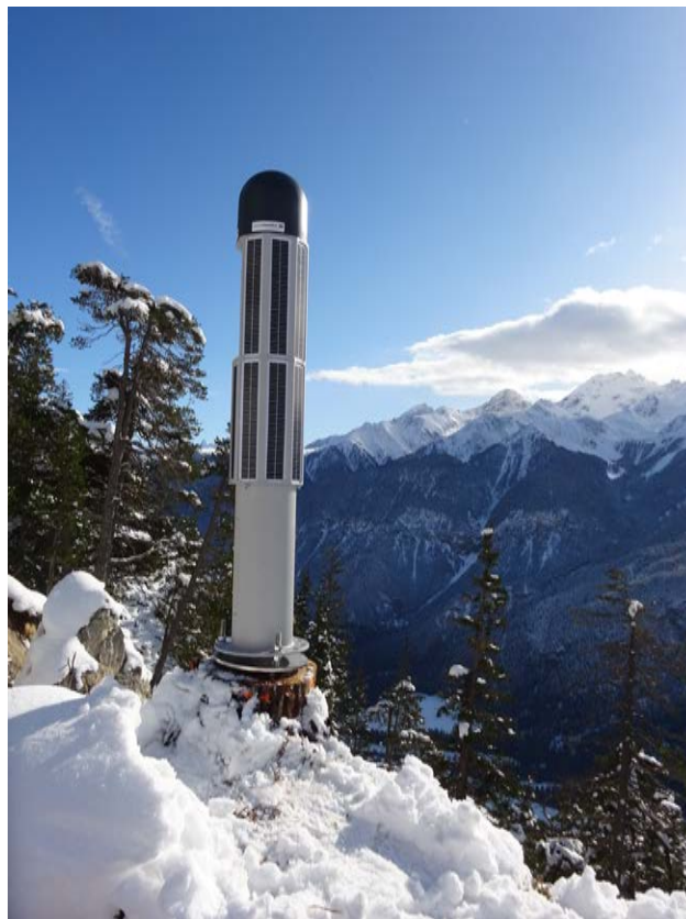
Ein hochpräziser GPS-Empfänger am Rücken Caltgeras © Grünenfelder AG
