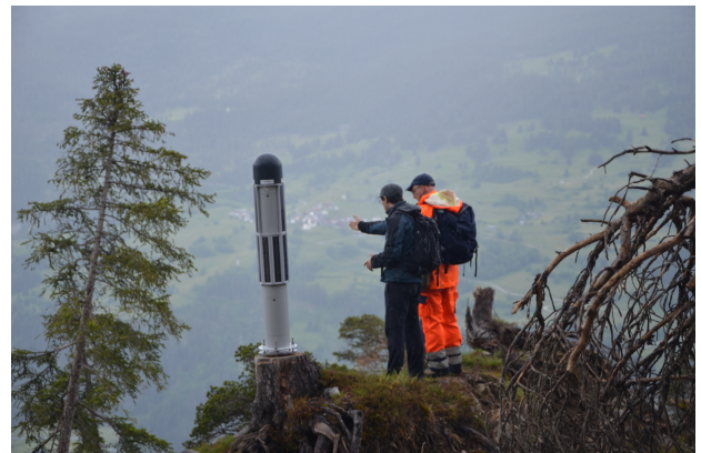
Feldbeobachtung: Geologen beurteilen eine der automatischen GPS-Messstationen hoch über Brienz/Brinzauls.
